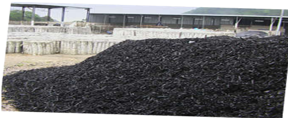
Figura 3.7: Serviço de trituração de pneus e da separação do aço e do nylon.
